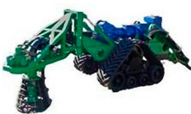
Rysunek 50. Jednostka OSBORS służąca do wydobywania paliwa na dnie (Źródło: NOAA, 2013)
