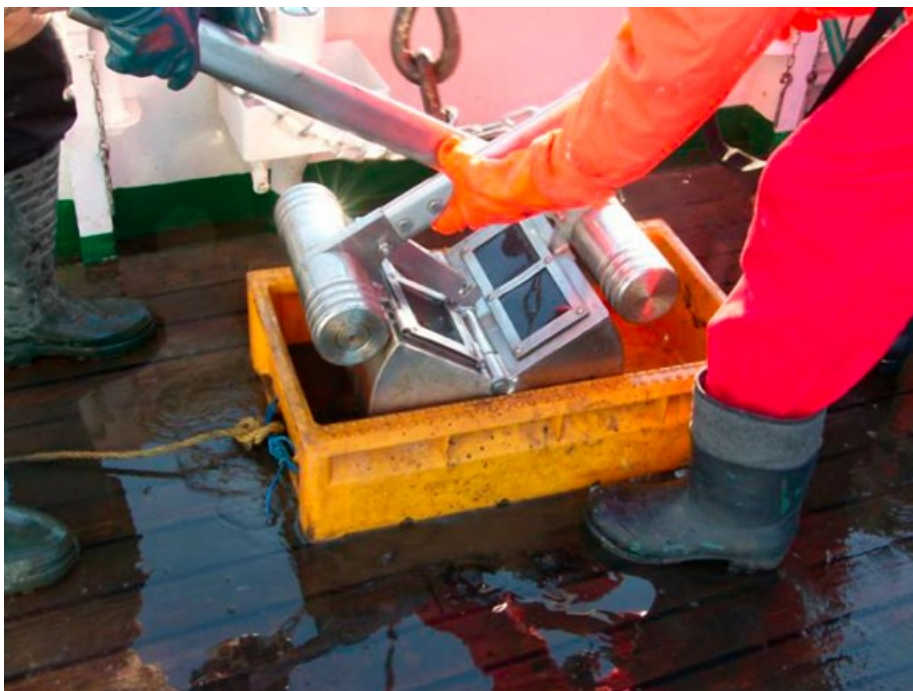
Rysunek 28. Próbnik Van Veena podczas pracy z R/V IMOR (Źródło: Instytut Morski w Gdańsku)
