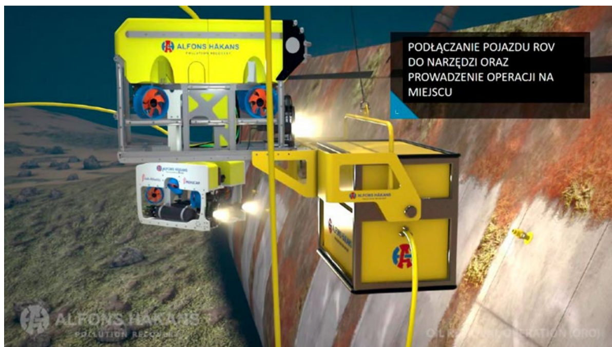
Rysunek 47. ROV z narzędziem Hot Tapping firmy Alfons Håkans (Źródło: Estonia and Park Victory cases info 2015-12-08 KR.pdf)
